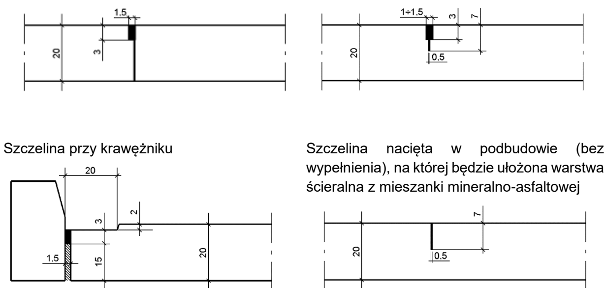
Rys. 1.1. Przykłady konstrukcji szczelin w podbudowie z betonu cementowego (wymiały w cm)
