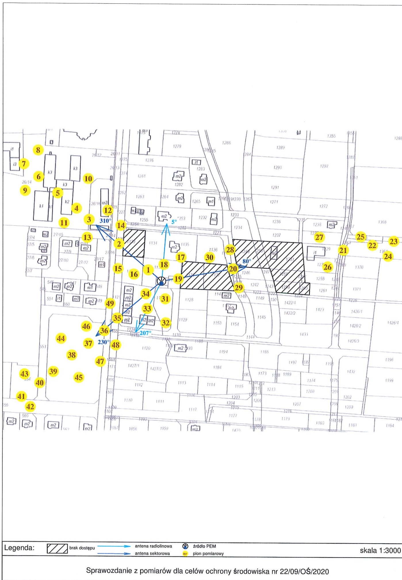
Rys. 2 Lokalizacja pionów pomiarowych
