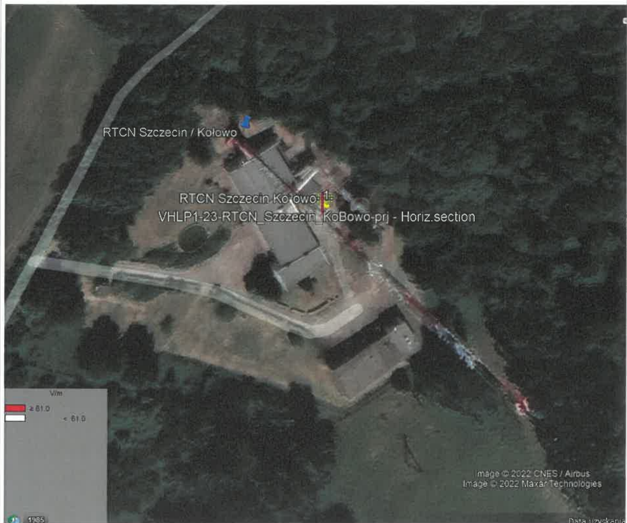
Rys. 2. Rzut poziomy rozkładu pola elektromagnetycznego anteny nowo projektowanej linii radiowej w otoczeniu RTCN Szczecin Kołowo przewidzianej do zainstalowania na wysokości 100 m nad poziomem terenu.
