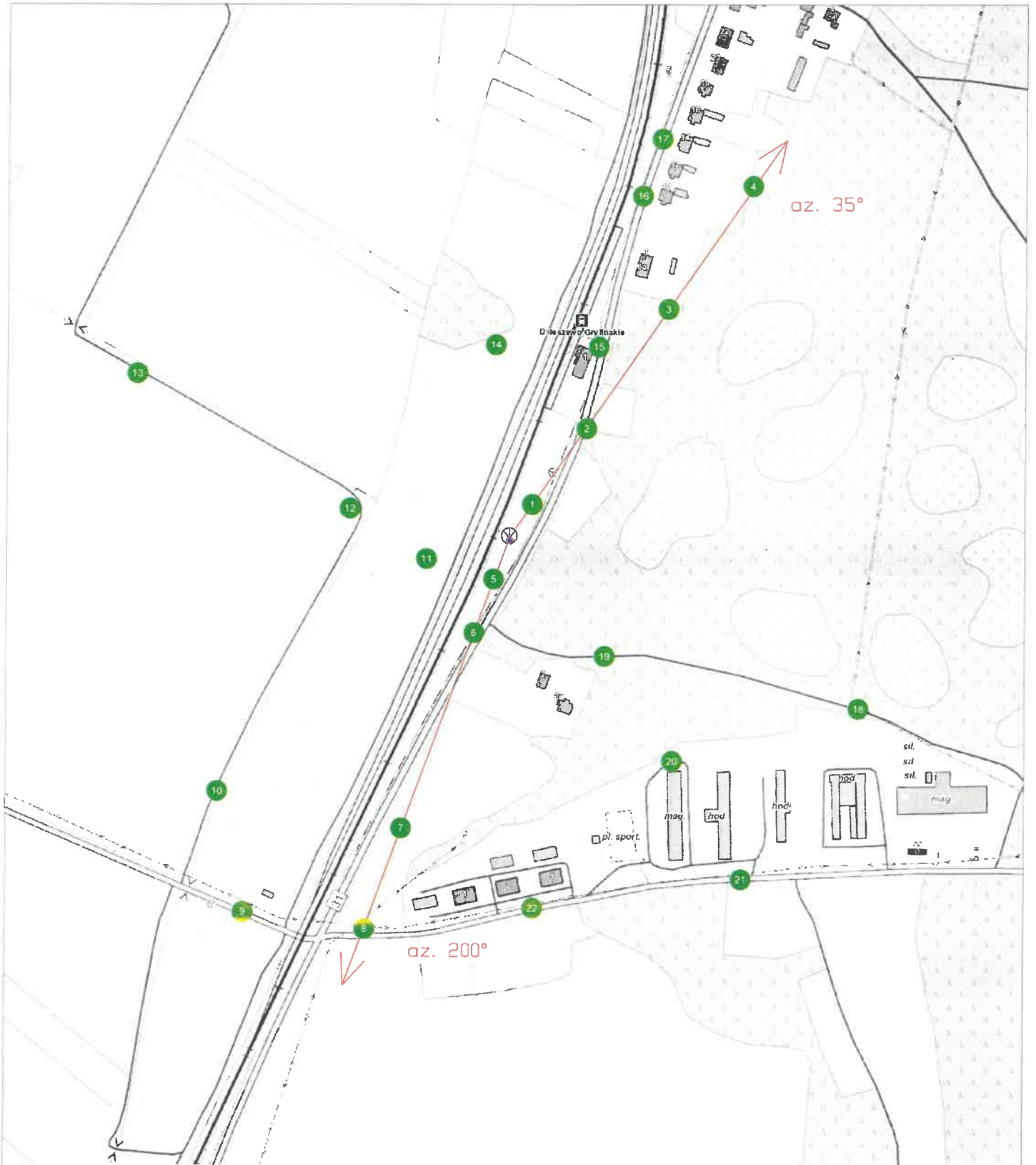
Rys.1 Lokalizacja pionów pomiarowych
